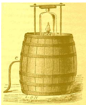
Fig. 7 – “ Lampe photo-sous-marine au magnésium ” (Boutan, 1900)
